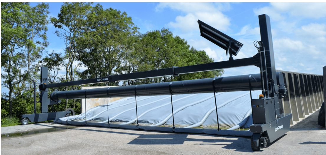
Figuur 27: Een sleufsilos met een automatisch afrolsysteem als afdekmiddel (Rotteveel, 2021)
