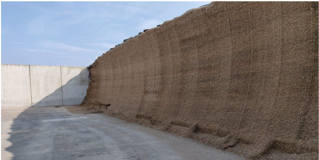
Figuur 14: Gebogen snijvlak bij de opslag van organisch materiaal in een sleufsilos die wordt uitgekuild met een freesmachine (Bedrijfsbezoek, 2021).
