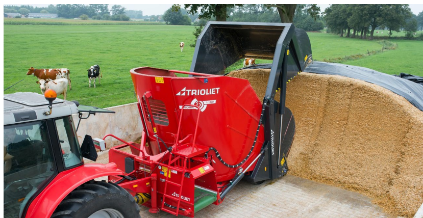
Figuur 17: Voorbeeld van een zelfladende voermengwagen met zaaglaadklep (Slootsmid, 2021).
