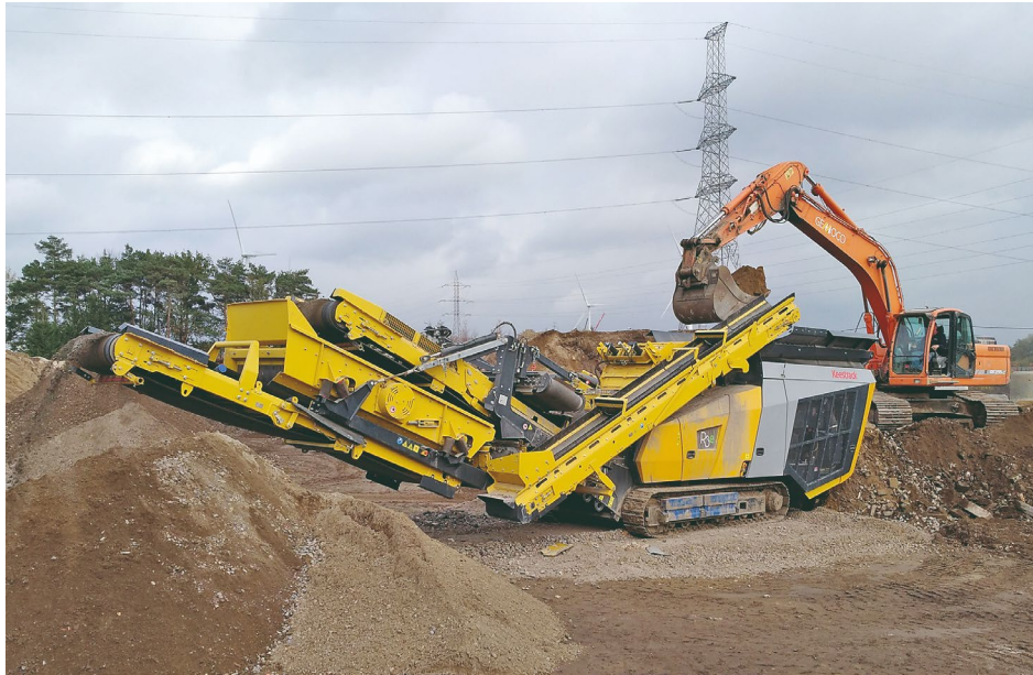
Figuur 18: Plug-in hybride mobiele percussiebreker 30 uitgerust met zeefinstallatie
