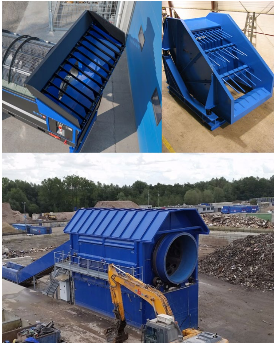
Figuur 5: Kiprooster op trommelzeef 22 (rechts boven), stangenzeef 23 (links boven), 3D-voorsorteertrommel 24 (onder)
