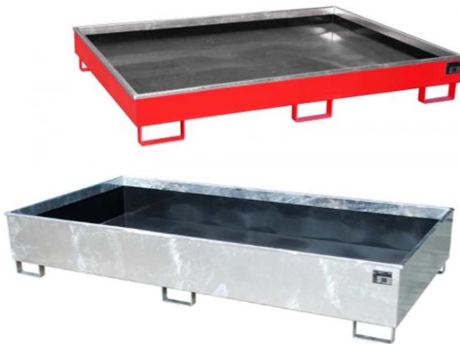
Figuur 17: Lekbakken uit (roestvast) staal met kunststof inlegbodem. Deze voldoet op zichzelf niet in alle gevallen aan de huidige voorwaarden voor minimumafstand en onbrandbaar karakter/brandbestendigheid in VLAREM, in het bijzonder bij opslag van IBC's (Bron: CGK)
