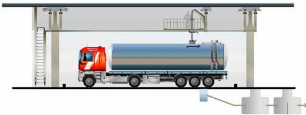
Figuur 22: Illustratieve weergave bovenbelading met ondergronds opvangsysteem voor gelekte vloeistoffen (Agentschap NL, 2012)
