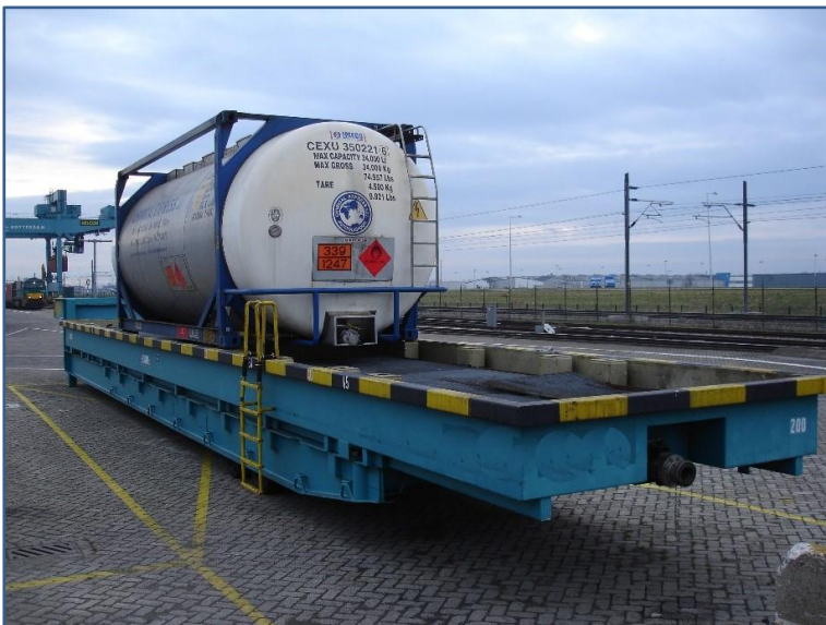
Figuur 19: Tankcontainer op een mobiele lekbak. Deze voldoet op zichzelf niet aan de huidige voorwaarden voor minimumafstand in VLAREM (Bron: CEFIC)
