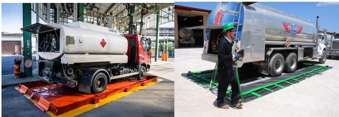
Figuur 28: tankwagens op een verplaatsbare vloeistofdichte vloer (bron: websites 26 Eccotarp en Spill911)
