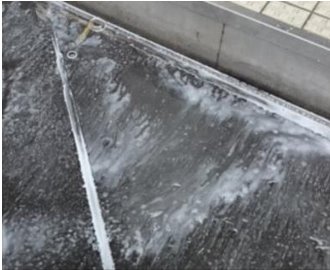
Figuur 42: Vorming van luchtballen bij inspectie van vloestofdichtheid met luchtteststelsel
