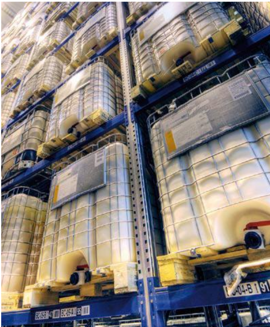
Figuur 5: Afbeelding van IBC's opgeslagen op palletstellingen (Bron: HSE, 2009)
