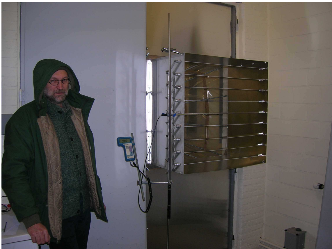
Figuur 21. Snelheidsmeting met thermische anemometer TSI(2) in raam met lamellen in horizontale stand
