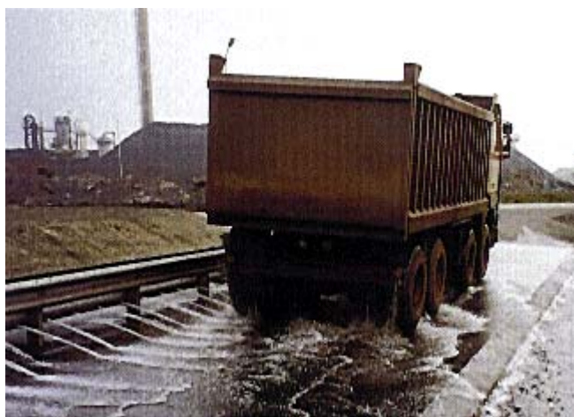
Figuur 23: Foto wielwasinstallatie [° 39]
