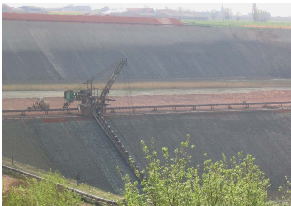
Figuur 22: Emmerbagger voor de ontginning van klei (Bron: Terca)
