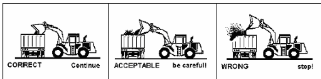
Figuur 24: invloed positie tijdens lossen met hydraulische laadschop
