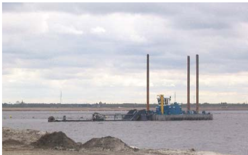
Figuur 12 : Natte zandwinning met zandzuiger voorzien van cutterkop (bron: Sibelco)
