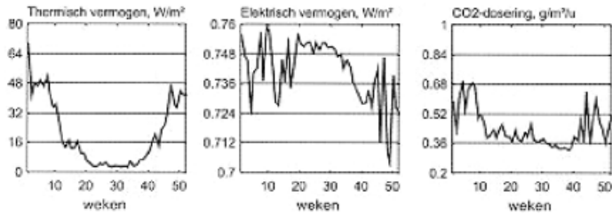
Figuur 4-14 Jaarverlopen van gevraagd thermisch vermogen, elektrisch vermogen en CO 2 .
