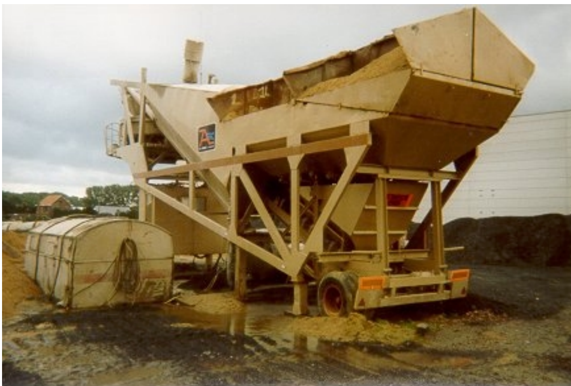
Figuur 43: Verplaatsbare Lambert centrale (linkerzijde)
