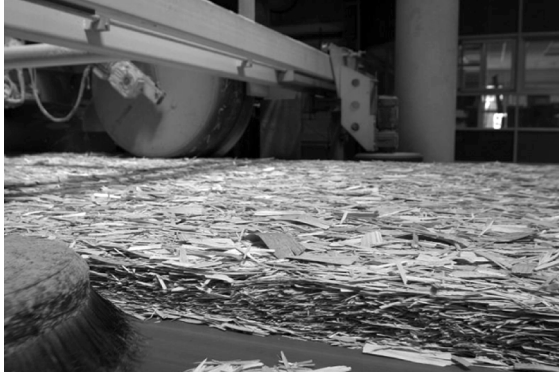
Figuur 38: Vervaardiging van oriented strand board (OSB) plaat
