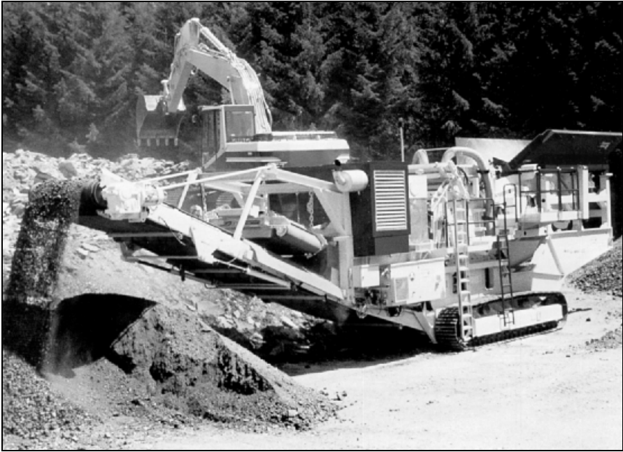
Figuur 14: Mobiele breekinstallaties op rupsen [°47]
