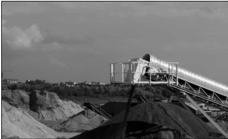
Figuur 18: Transportband met afgeschermd uitlaat met sproei-installatie [bron DD Recycling]
