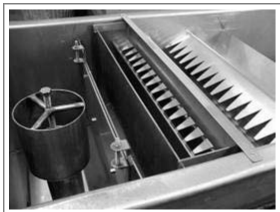
Voorbeeld van een olieafscheider met gravitaire werking (Suparator)
