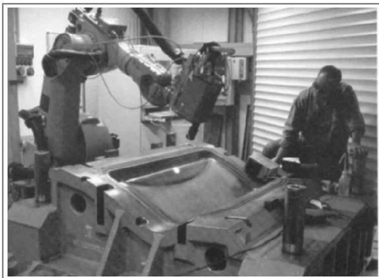
Figuur 3.12: Diodelaser gemonteerd op robot tijdens het harden van matrijsranden
