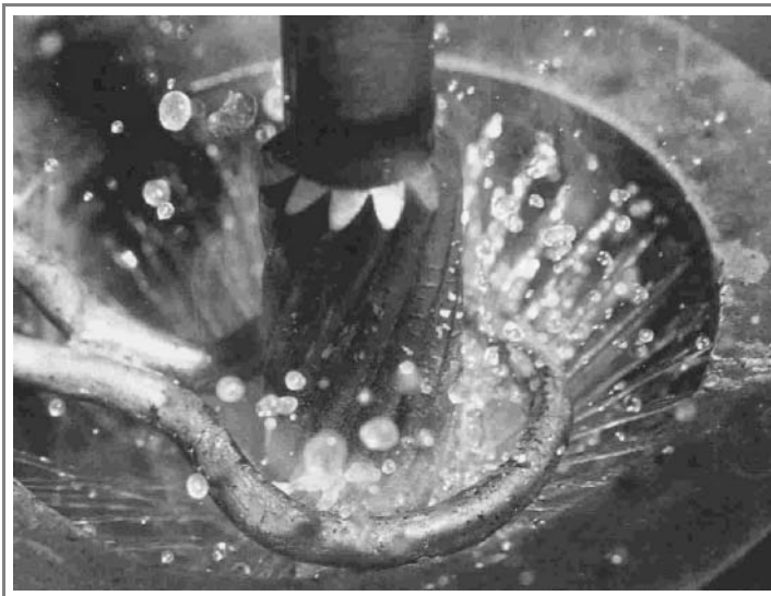
Figuur 3.11: Inductieharden van een tandwiel
