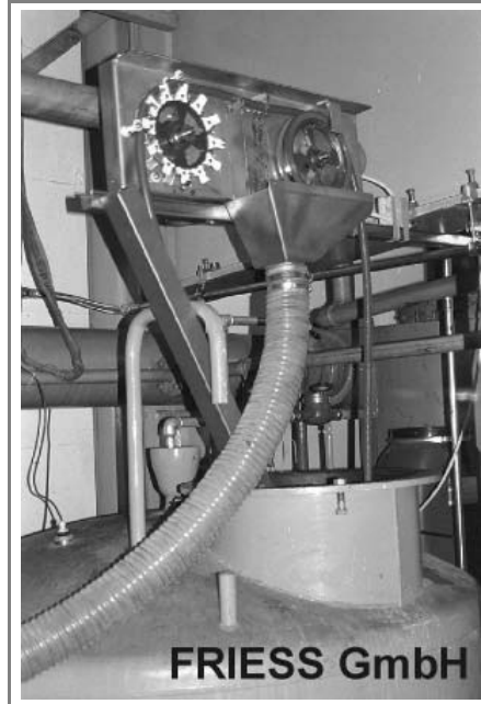
Voorbeeld van een olieafscheider met skimmer (Friess)
