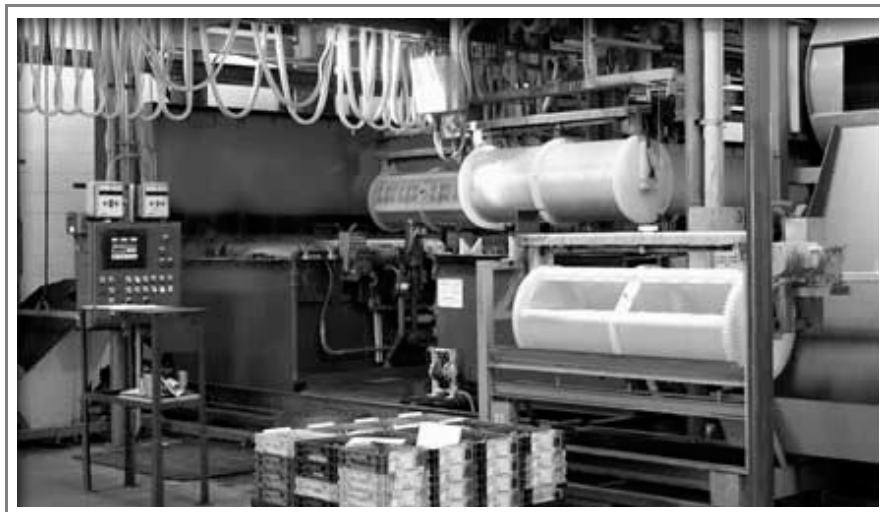
Figuur 3.17: Dompellijn voor kleine stukken met trommel
