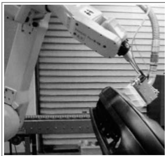
Figuur 3.5: Vlambehandeling van kunststoffen http://www.kbrasch.co.jp/
