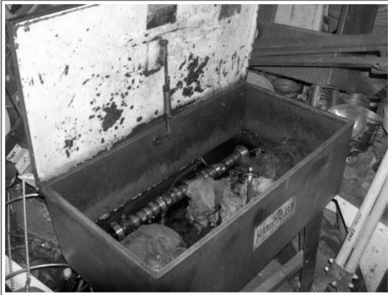
Figuur 3.4: Voorbeeld van een eenvoudige installatie voor dompelontvetten
