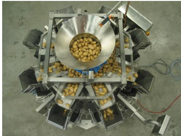
Figuur 31: Verdeelmachine voor verse of diepvriesproducten (website Strijbos, J.)
