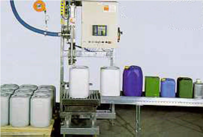
Figuur 16. Afvulininstallatie die enkel de nodige hoeveelheid afvult (semi-automatisch; Van Deynze et al., 1998).
