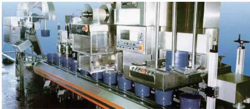
Figuur 14. Volledig geautomatiseerde afvulininstallatie inclusief opzetten van de potten en etiketteren (Van Deynze et al., 1998).
