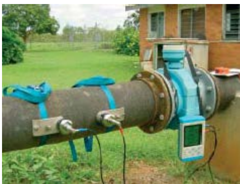
Figuur 4: clamp-on ultrasone debietmeting in praktijk
