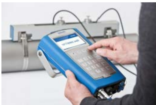
Figuur 4: clamp-on ultrasone debietmeting in praktijk
