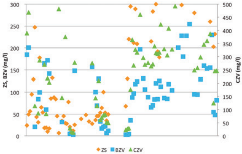
Figuur 75: CZV, BZV en ZS concentraties groenteverwerkende bedrijven groothandel – voor uitzuivering van de data – schaal 2.
