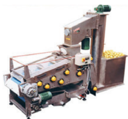
Figuur 25: Bandpers (foto: www.vinimare.nl , 2011)
