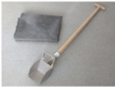
Figuur 16 : bemonsteringsschep met rechtopstaande rand
