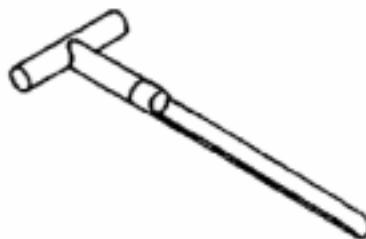
Figuur 8 bemonsteringsschop met rechtopstaande rand
