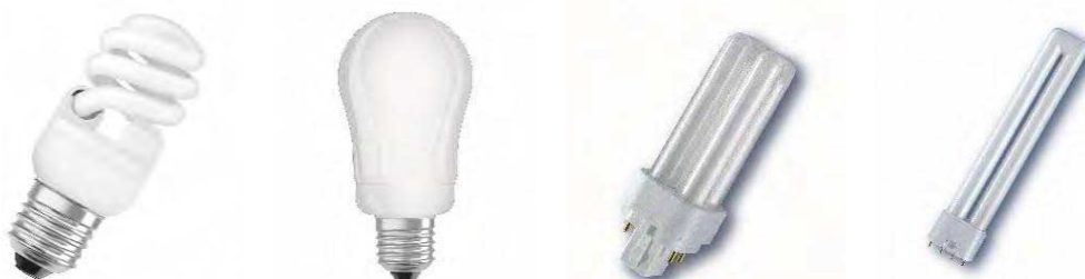
Figuur 255: Compacte TL-verlichting met geïntegreerde ballast tubevormig (uiterst links) en ballonvormig (links) en compacte TL-verlichting met externe ballast tubevormig (rechts en uiterst rechts)
