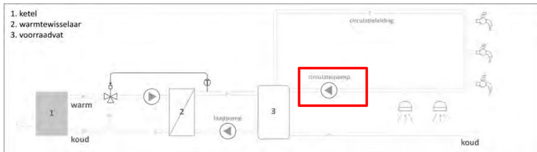
Figuur 221: Circulatieleiding met circulatiepomp bij een voorraadvat
