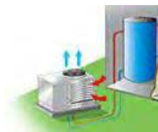
Figuur 194: Schematische voorstelling van een lucht/water koude-opwekker
