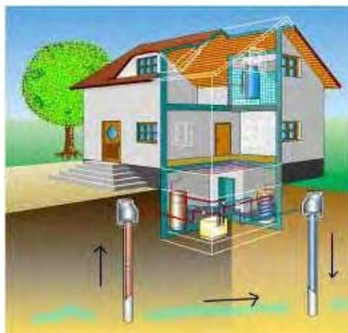
Figuur 195: Schematische voorstelling van een water/water koude-opwekker.
