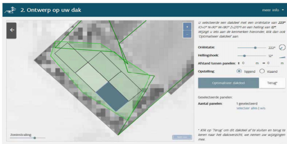
Figuur 3: Aanpassen ontwerp installatie in de zonnekaart en weergeven oriëntatie van de panelen
