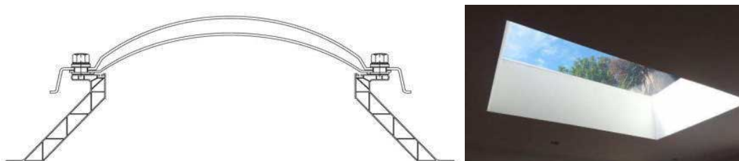
Figuur 53: Koepels op een plat dak worden meestal op een kunststof profiel gemonteerd (recht of schuin profiel, zoals links weergegeven). Soms worden de profielen aan de binnenzijde afgewerkt en moet het profiel langs buiten worden vastgesteld (zie foto rechts).
