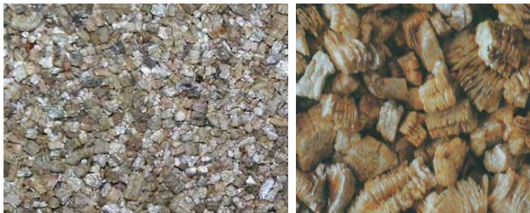
Figuur 112: Vermiculiet: platen (links) en korrels (rechts)
