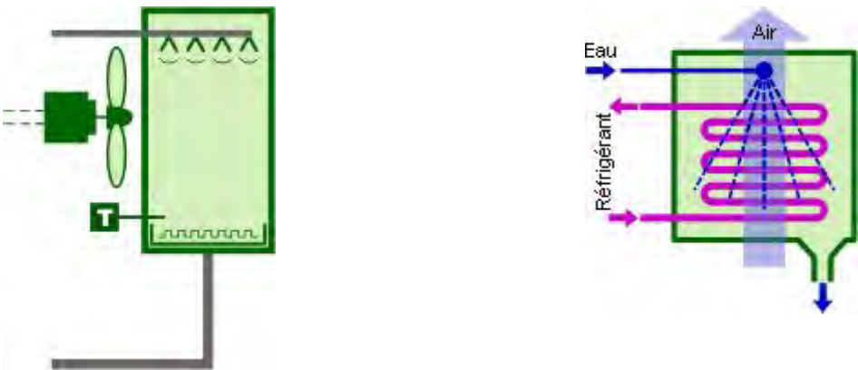
Figuur 41: Schematische voorstelling van een open koeltoren (links) en een gesloten koeltoren (rechts).
