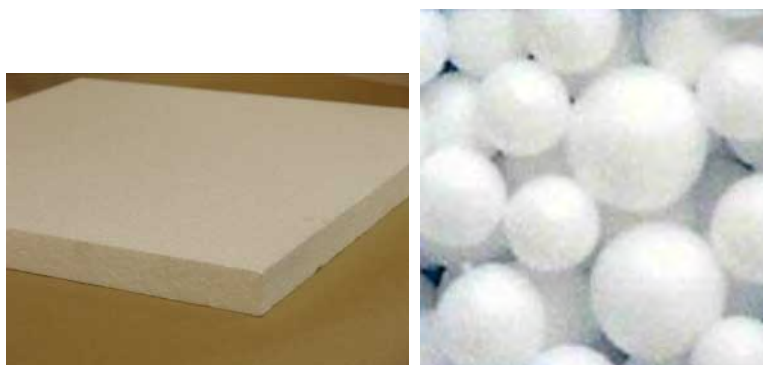
Figuur 107: Geëxpandeerd polystyreen (EPS) – platen (links) ingespoten bolletjes (rechts)
