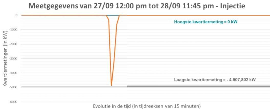
Om het Nominale Referentievermogen te evalueren van een Leveringspunt dat elektriciteit op het net injecteert, bepaalt ELIA de hoogste vermogensvariatie. In het geval van injectie wordt deze variatie berekend door de absolute waarde te nemen van het verschil tussen de laagste kwartiermeting en het minimum van de hoogste kwartiermeting en nul.
