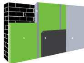
1. Buitengevel | 2. Isolatie | 3. Dampscher 4. Binnenafwerking 5. Stijl- en regelwerk (optioneel)
