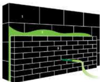
1. Dragende muur | 2. ingeblazen isolatie 3. gevelstenen / gevelbekleding
