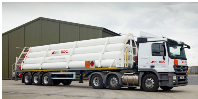
Figuur II.2.3.1: Voorbeeld van een tube-trailer met 9 stalen drukcilinders (max. 200 bar)
