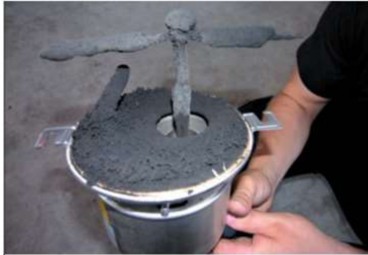
Figuur 34: Elektrodeklem van de Zumikon ESP, gedemonteerd voor reiniging na gebruik (Hartmann, Turowski, & Kiener, 2010)
