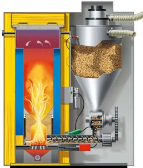
Figuur 26: Pelletkachel met automatische toevoer van pellets met een intern opslagvat (Omniconfort, 2019)
