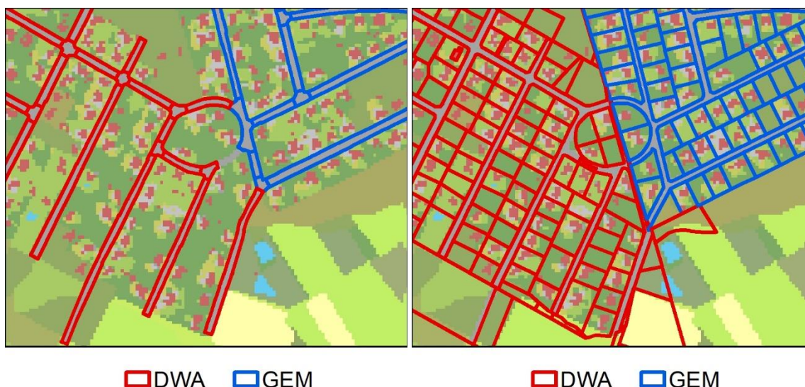
Figuur 7: Voorbeeld van de afbakening van wegen en administratieve percelen die wellicht verbonden zijn met een gemengd rioleringsnetwerk (GEM) of een droog weer afvoer (DWA).
