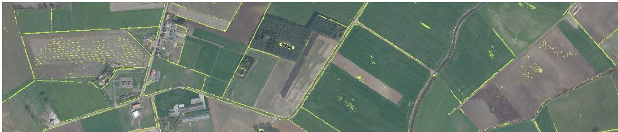
Figuur 15: kartering van grachten via topografische analyse op basis van het digitaal hoogtemodel II (1 meter resolutie). Niet alle grachten zullen drainerend zijn, enkel wanneer er ondiep bodemwater aanwezig is én wanneer er indicaties zijn van een intensief landgebruik.
