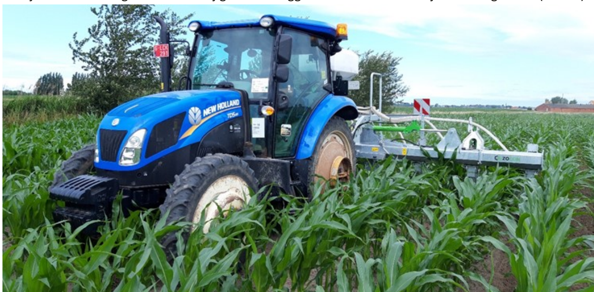
Foto 6 Inzaaien van gras tussen de maïsrijen met een aangepaste zaaimachine (bron: CVBB)
