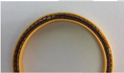
Figuur 19: Verbinding in de kop van het mondstuk van de verdeelslang aan de verdeelzuil (Fluxys, 2016)
