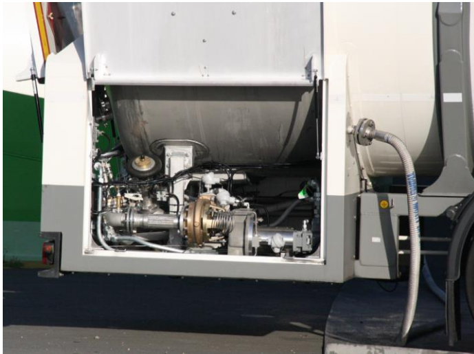
Figuur 32: Omkasting van de pomp en het leidingwerk bij een LNG bunkerende truck
