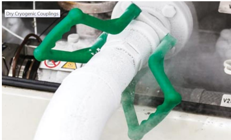
Figuur 31: Afbeelding van een in werking zijnde cryogene snelkoppeling (Manntek, s.d.)
