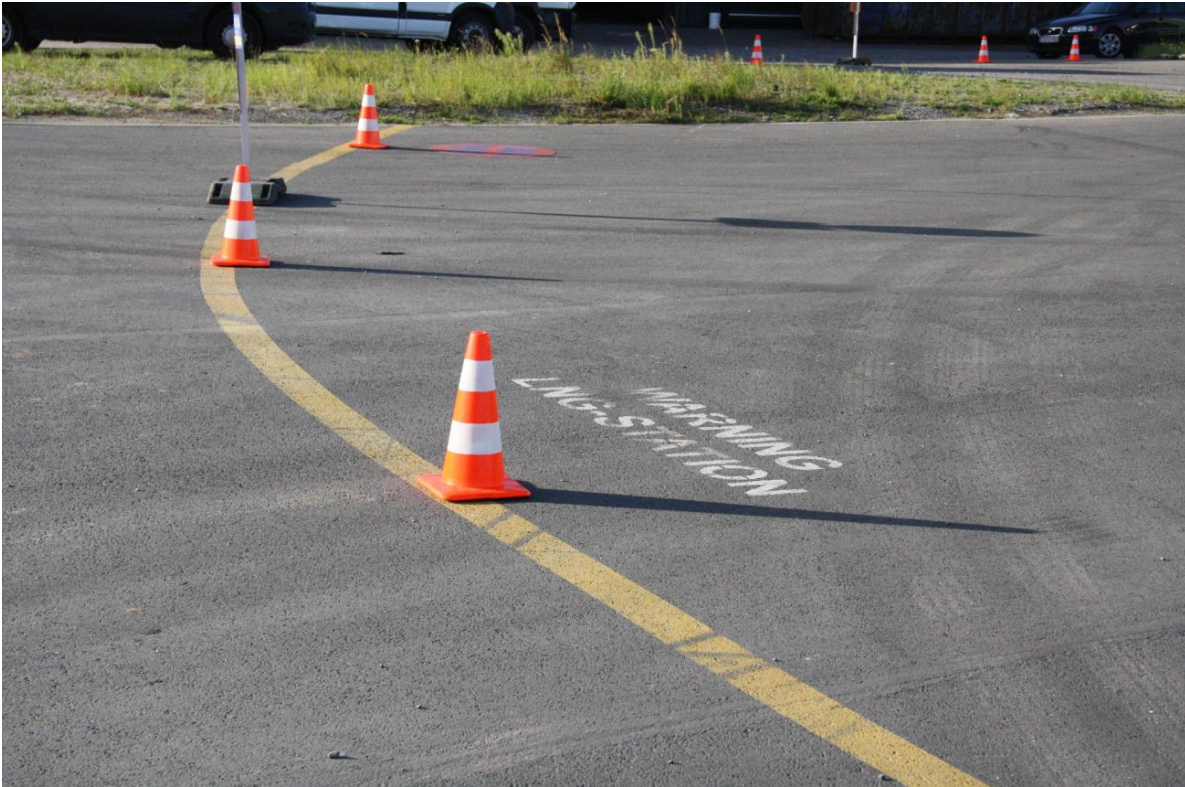
Figuur 22: Aanduiding van de veiligheidszone op het truck-to-ship-bunkerstation in Antwerpen
