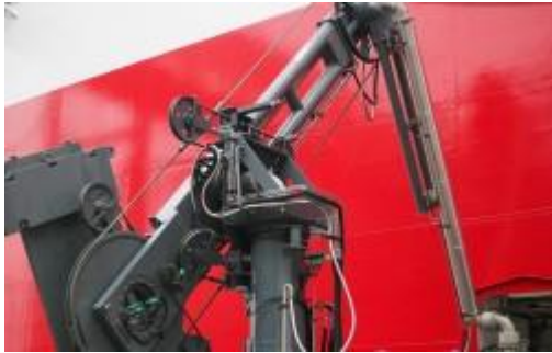
Figuur 25: Voorbeeld van een vaste laadarm voor bunkering (Skangas, 2015).
