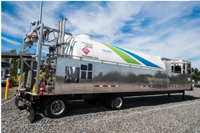
Figuur 4: Een verplaatsbare LNG-afleverinstallatie (Morgan, 2013).
