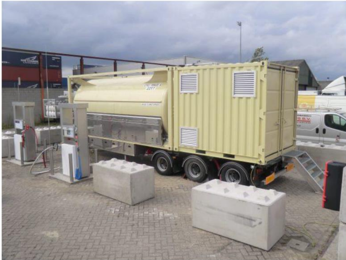
Figuur 3: Voorbeeld van een verplaatsbare afleverinstallatie (Wensink, 2013).
