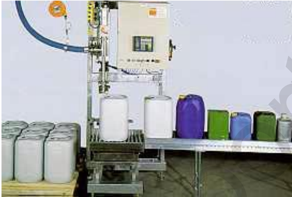
Figuur 16. Afvulinstallatie die enkel de nodige hoeveelheid afvult (semi-automatisch; Van Deynze et al., 1998).
