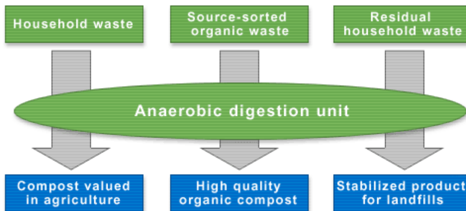
Figuur 18: mogelijke voorbehandelingsopties van het Valorga voorbehandelingsstelsel
