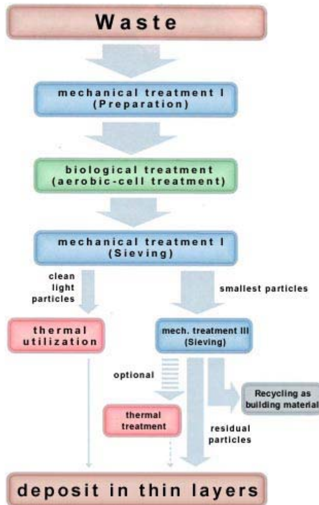
Figuur 40: Combinatie van de modules van het FABER-AMBRA®-proces
