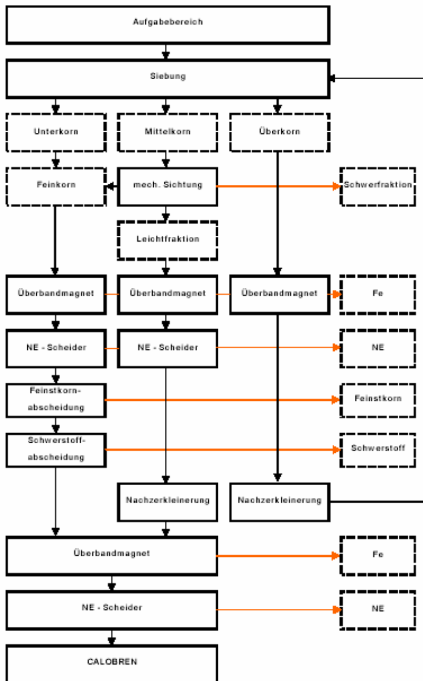
Figuur 34: Mechanische nabehandeling van de gestabiliseerde hoogcalorische fractie tot de secundaire brandstof Calobren ® , volgens het Nehlsen-concept
