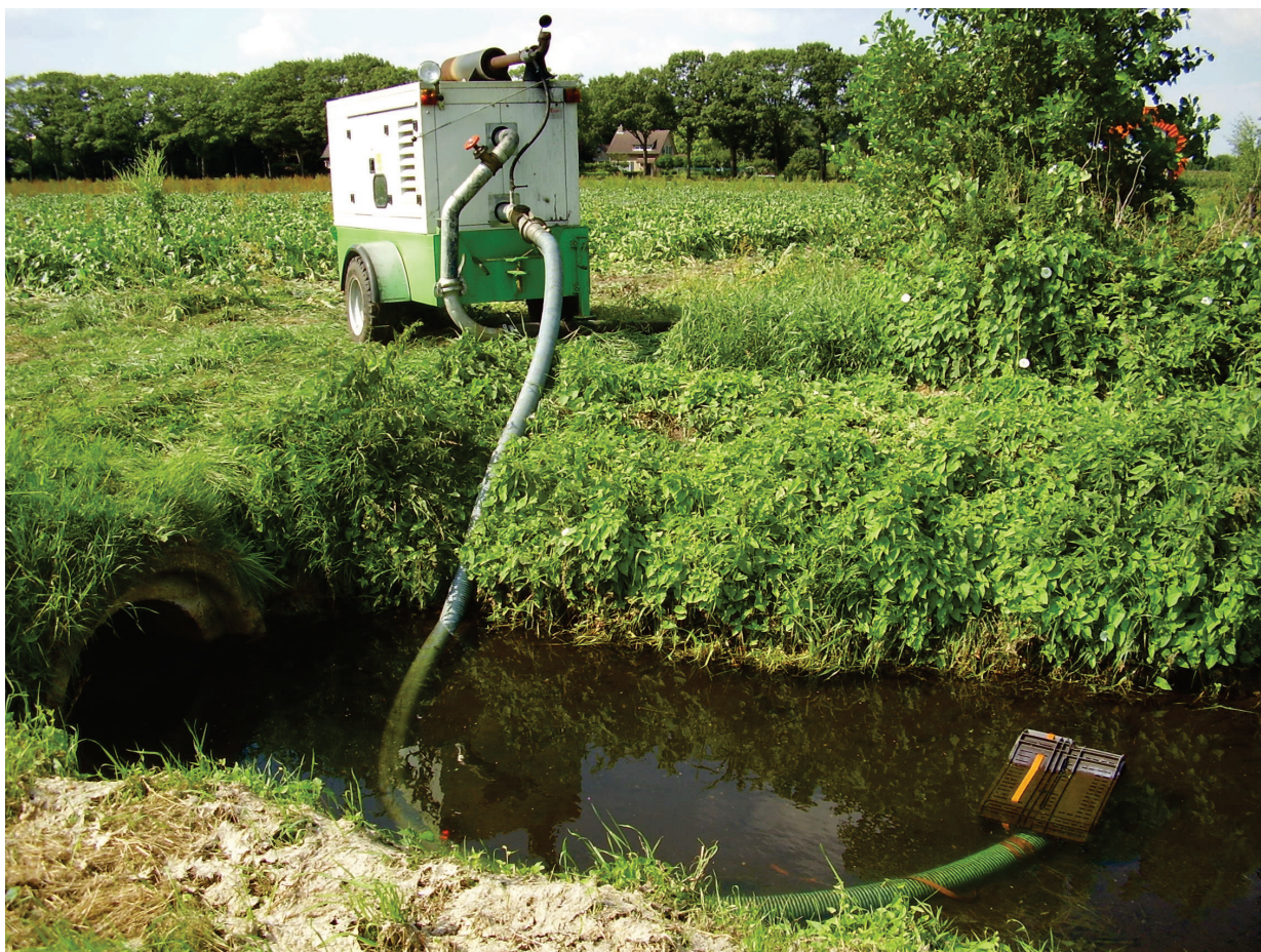
Figuur 22: Mobile opstelling van een onttrekking van oppervlaktewater uit een gracht (Waterschap De Dommel, 2020))
