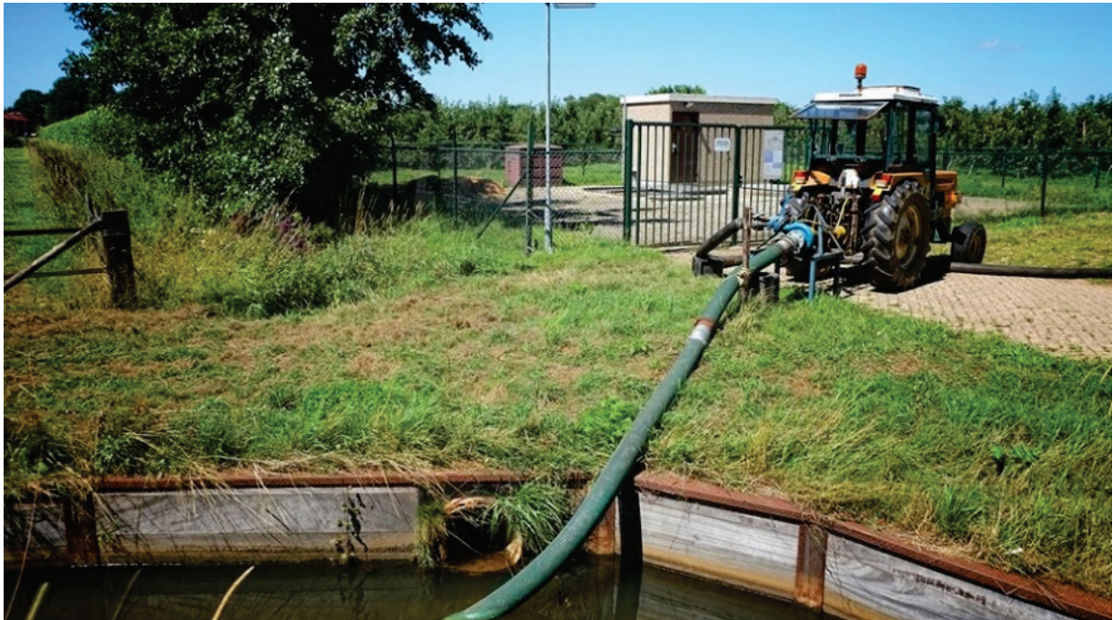
Figuur 20: Tijdelijke opstelling voor het onttrekken van oppervlaktewater uit een waterloop (H2O Waternetwerk, 2019)
