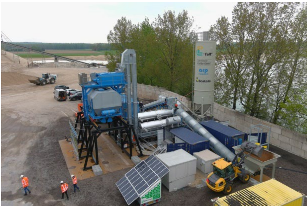
Figuur 40: Elektrische asfaltcentrale Helice (ARP Equipment & Boskalis, 2022)
