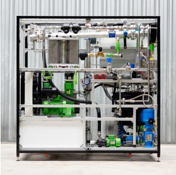
Figuur 38: Generator op mierenzuur (TU/e, 2018)
