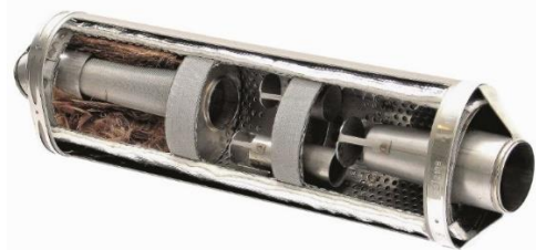
Figuur 19: Doorsnede van een uitlaatdemper met meerdere kamers
