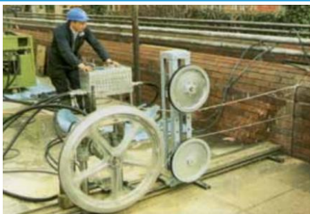
Figuur 32: Diamanddraadzaag (HSE, 1997)
