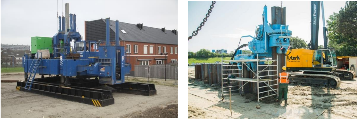
Figuur 26: Hydraulische indrukinstallatie voor prefab-betonpalen (links) en hydraulische indrukinstallatie voor damwanden (rechts) (bronnen: www.drukpaal.nl & https://www.sterk.eu/ )
