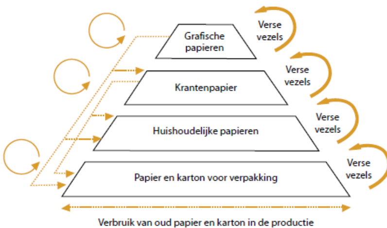
Figuur 18. Schema van de recyclage van verschillende papier- en kartonsoorten, en de inbreng van verse vezels (FOGRA, 2008).
