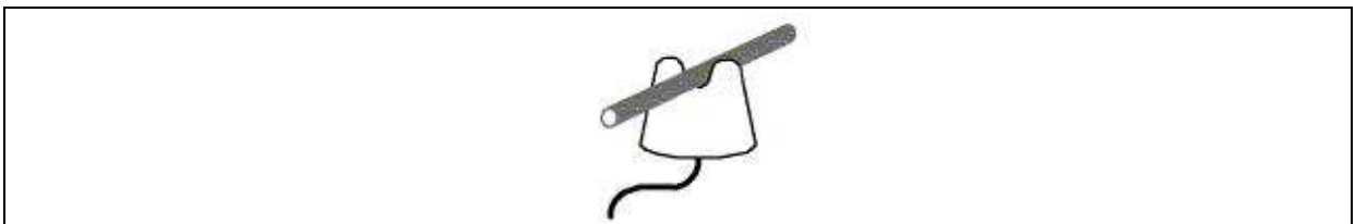
Figuur 5.24. Plaatsingswijzen van elektrische leidingen – Op isolatoren
